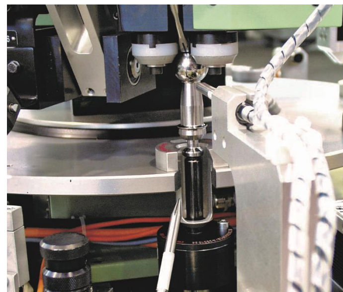
ボールピボット／グローブジョイント検査
