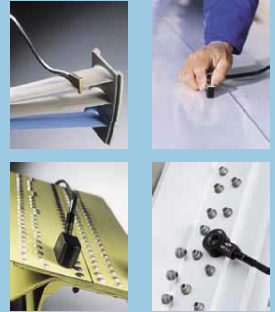
ELOTEST M2V3は高周波を用いた高合金鋼製部品の割れ検出から中周波を用いた割れ及び腐食検査や低周波を用いた多層構造内の応力亀裂に至るまで、全てのマニュアル検査を行うことが出来る。
