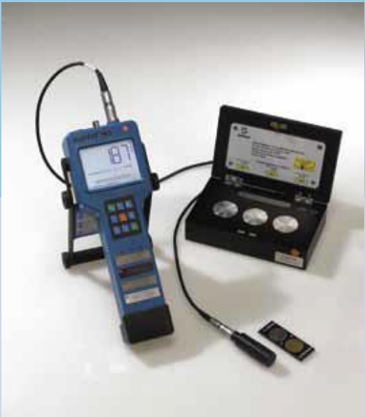
ELOTEST M2 V3を用いた導電率及び膜厚測定
